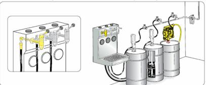
Ejemplo de montaje en instalación fija. Ejemplo de montaje en instalación fija con el bar de aceite conectado a una
