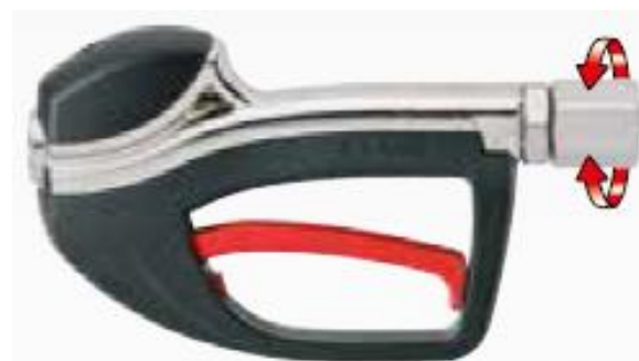
Empuñadura en aleación de aluminio con articulación de entrada H 1/2" y botón de bloqueo de palanca
