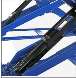
**Cerraduras mecánicas** con 18 posiciones de bloqueo, se activan automáticamente y se liberan neumáticamente, lo que garantiza la máxima seguridad cuando el elevador está en posiciones elevadas.
