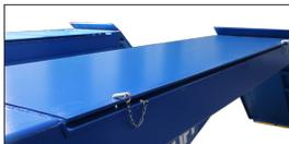
Placa deslizante trasera de 2100 mm diseñada para adaptarse a un mayor rango de distancia entre ejes para alineaciones de dos y cuatro ruedas.
