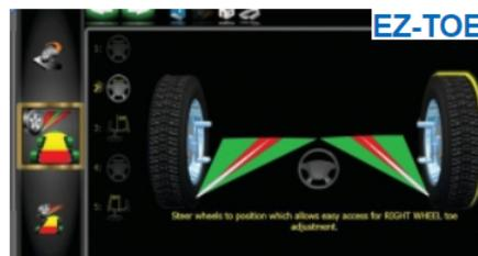
Posibilidad de girar la dirección para acceder al ajuste de la convergencia manteniendo los datos del vehículo centrado.
