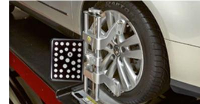
La colocación autocentrada permite medir con precisión las dimensiones del vehículo. Las uñas de llanta reversibles amplían las posibilidades de sujeción sin accesorios adicionales y permiten la colocación de llantas con tapacubos.
